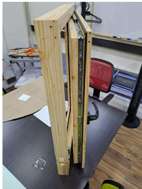
Figura 23. Ventana de madera con sus diferentes componentes
