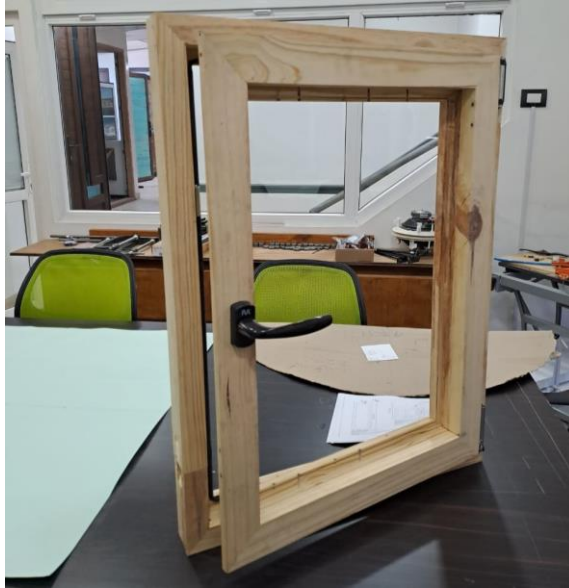
Figura 22. Ventana termoacústica en madera
