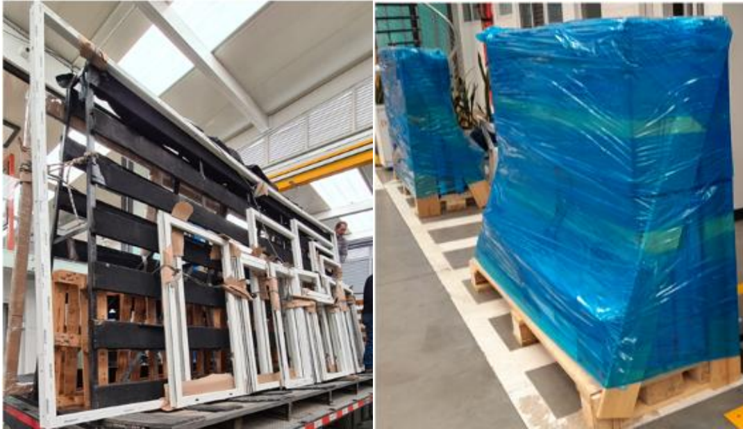
Figura 26. Embalaje de las ventanas para su transporte y almacenaje
