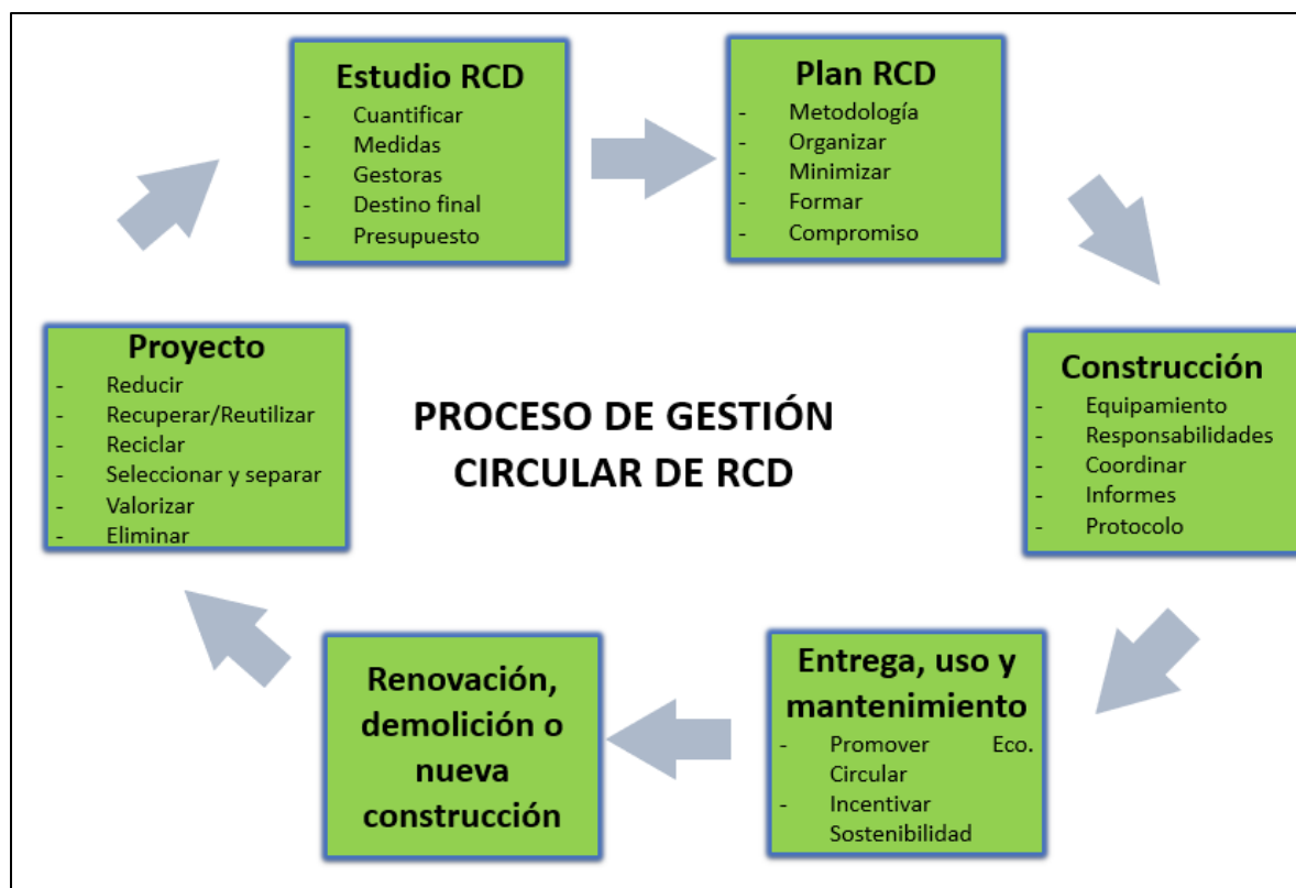
Figura 7: Esquema del proceso de gestión de RCD en la Economía Circular. Fuente: Gallardo et al., (2021).
