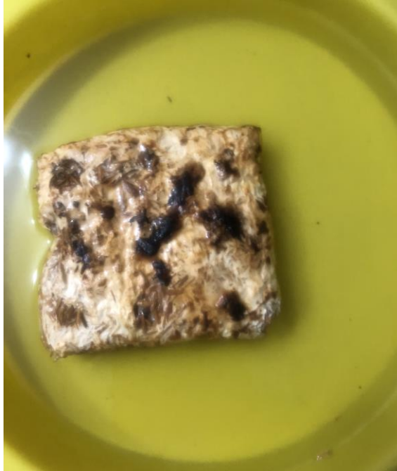
Figura 120 Ensayo absorción de agua fin prueba Fuente: Elaboración propia 2023
