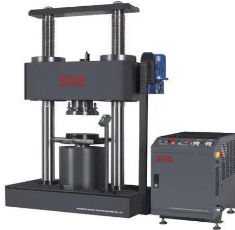
Figura 43 Máquina de prueba de compresión 1000 - 5000 kN | HCT Series Type C. Fuente: (Wance, 2023).
