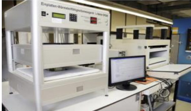
Figura 46 Máquina de ensayo de conductividad térmica. Fuente: (Laboratories, 2023)
