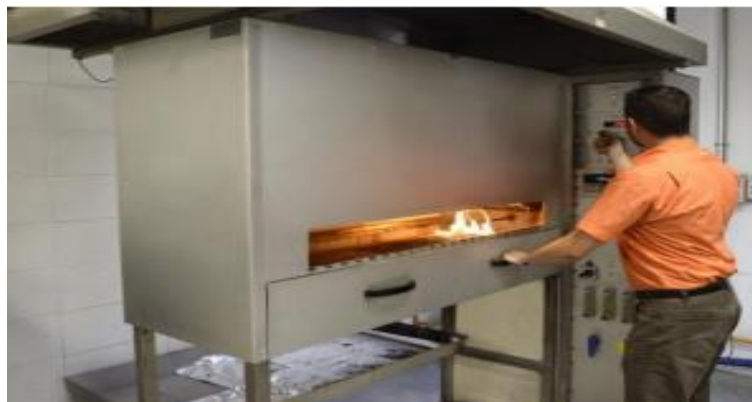
Figura 44 Máquina de prueba reacción contra el fuego. Fuente: (Laboratories, 2023)
