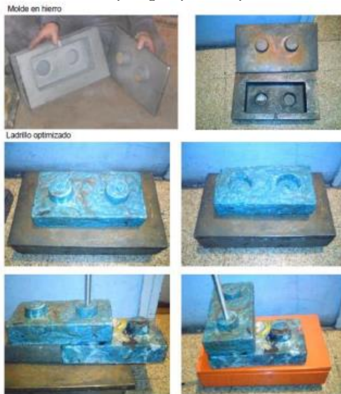
Figura 15. Ladrillos tipo lego a partir de polietileno de alta densidad
