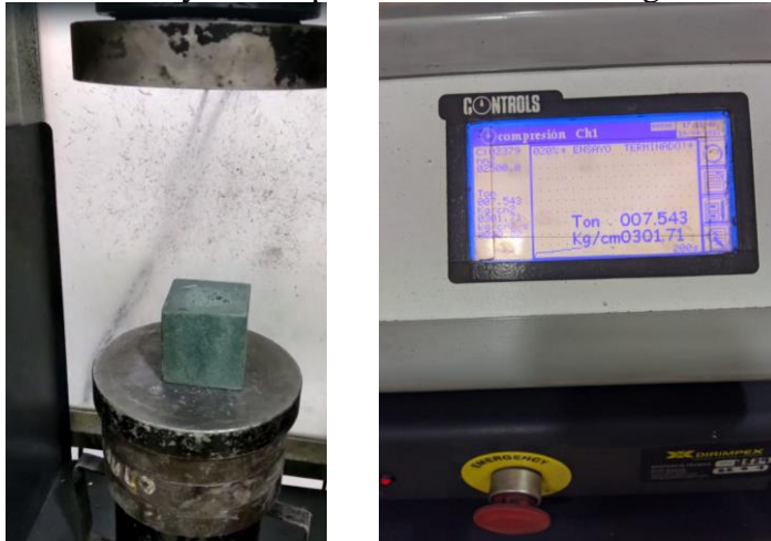
Figura 18. Ensayo a compresión del material elegido
