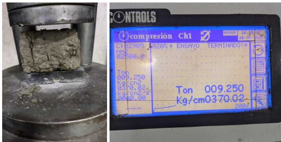
Figura 27. Prueba básica a compresión (Autores, 2023)
