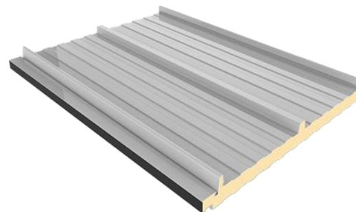
Al igual que la anterior, en la actualidad hay tejas tipo Sandwich creada en el año 2009 en España metálica sin traslazo longitudinal, en lámina de acero galvanizado y prepintada con pintura poliéster al horno por ambas caras brindando confort termo acústico en su interior. (Grupo Panel Sandwich, 2022)
