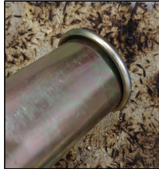
Figura 36: Prueba al fuego con soplete cascarilla de arroz,
