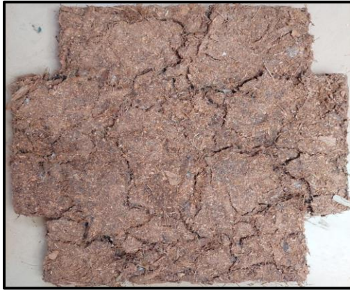
Figura 28 Prueba de aglutinante harina de trigo
