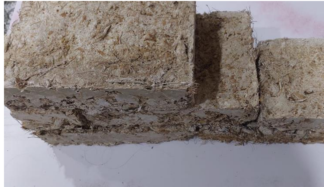
Figura 29 Muestras con fibra de coco cal y cemento blanco
