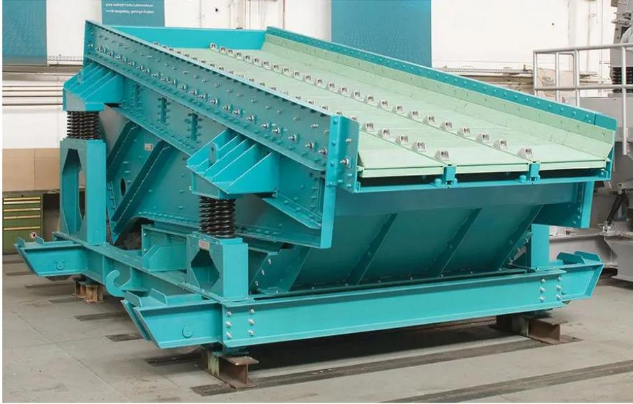
Criba con capacidad de 3.000 toneladas hora, corte de separación de hasta 100 mm (GmbH, 2022)
