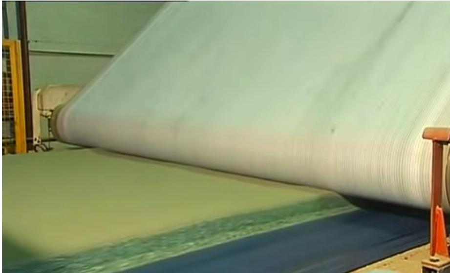
Las partículas que conformaran un tablero son pre prensadas en frío, esto para facilitar su transporte. (Confemadera, 2011)
