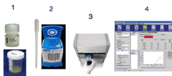
Figura 8: Técnica molecular de GeneXpert Carba. (1) solución buffer y muestra, (2) cassette del test GeneXpert Carba (3) equipo de biología molecular GeneXpert Carba (4) panel de resultados de la prueba mostrando positividad mediante fluorescencia, lo cual indica la amplificación del gen que confiere la resistencia Tomada de: 86
