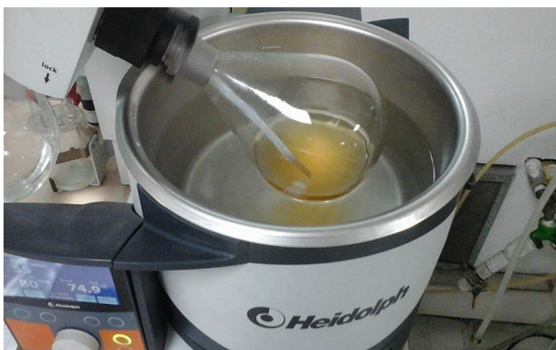
Figura 6: Muestra sometida en el rotaevaporador. Fuente: Propia
