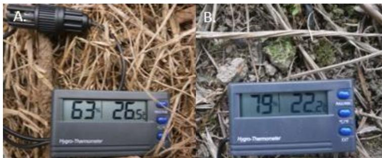
**Figura 9.** Medición de humedad y temperatura en campo con termohigrómetro. A. Medición en finca La Comadreja. B. Medición en finca San Antonio. Autoras: Beltrán, Cuevas. 2018
