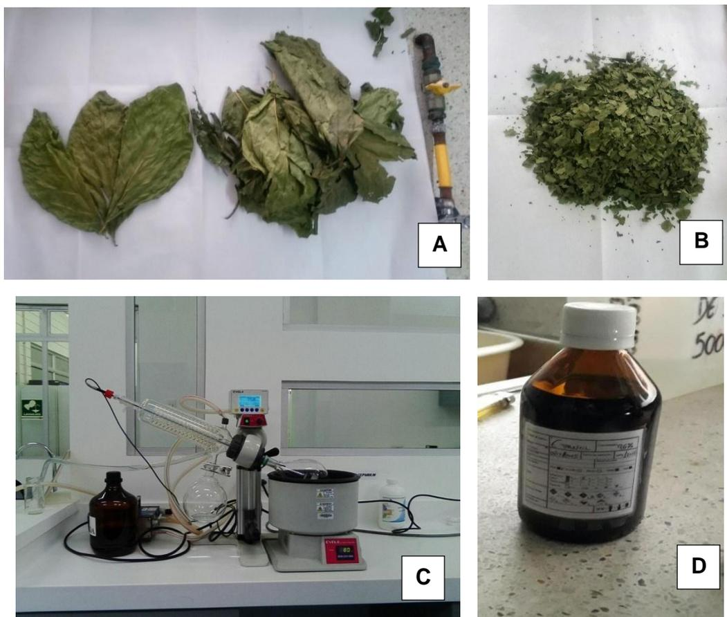
**Figura 6: Proceso de obtención del extracto etanólico.** A) Hojas secas de noni. B) Hojas de noni maceradas con mortero. C) Rotoevaporador. D) Hojas de noni en etanol absoluto, almacenado en frasco ámbar. Tomada por Camila Cortes y Judith Espitia. Laboratorio de investigación 1 UCMC.
