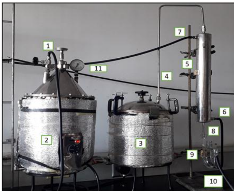
Figura N°8. Equipo de destilación por arrastre con vapor 1. Entrada de agua 2. Caldera de calentamiento 3. Alambique 4. Tubo de salida de aceite y vapor 5. Condensador 6. Entrada de agua al condensador 7. Salida de agua del condensador 8. Salida de la mezcla 9. Recipiente para captura de la muestra. 10. Salida de residuos tipo hidrolato. 11. Manómetro. Tomada de: (49)
