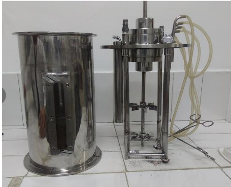
Imagen 3 Biorreactor Tecferm 5L. Foto tomada en el laboratorio, elaborada por el autor, 2018.
