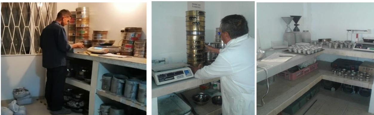
**Figura 18. Ejecución ensayo de granulometría. Fuente: Propia**
