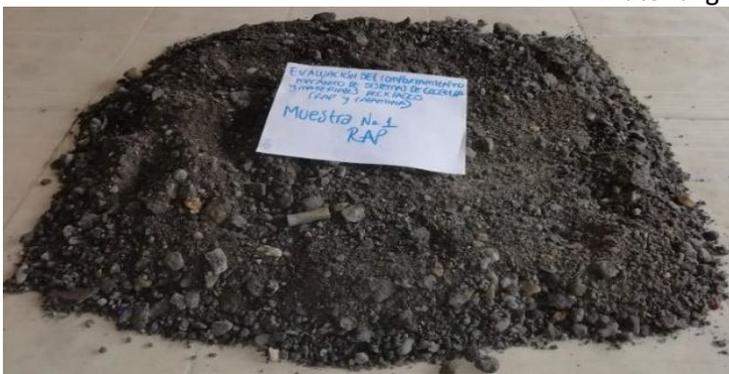
**Figura 17. Muestra de pavimento asfáltico reciclado (RAP). Fuente: Propia.**
