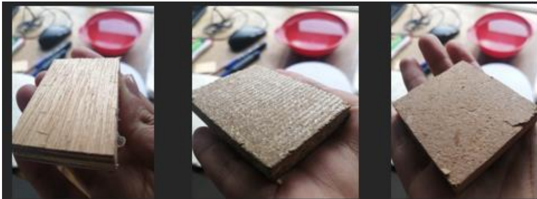
Figura 76. Muestra de piezas paso 5 ensayo de humedad
