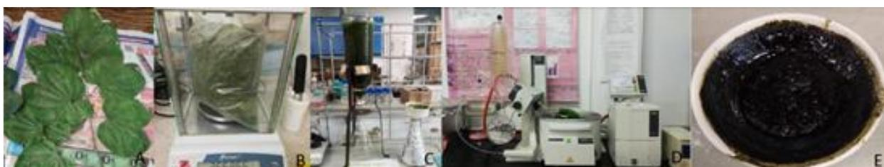
**Figura 5. Proceso para la obtención del extracto etanolico.** A. Hojas de *B. variegata Linn* B. Material vegetal seco y siendo pesado. C. Metodo del percolador, al cual fue expuesto el extracto. D. Rotaevaporador BUCHI B-100. E. Extracto terminado.
