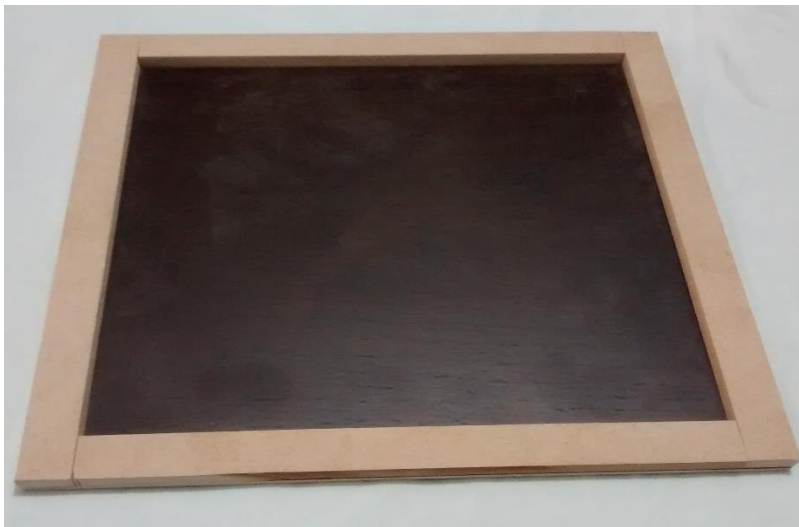
Ilustración 14 Molde de madera triplex para para la lámina de cielo raso (2019) Autores
