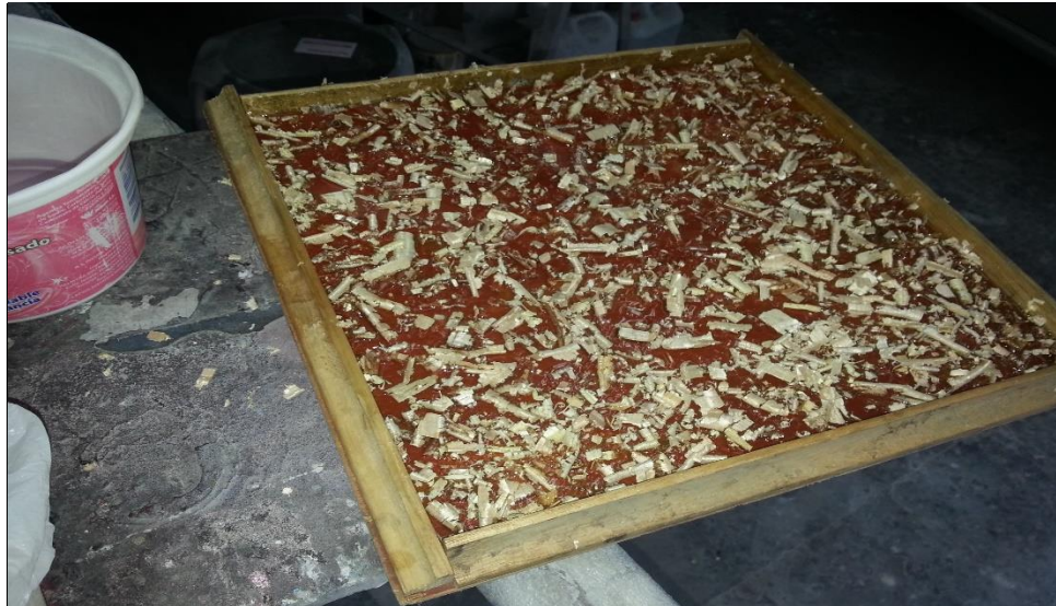
Ilustración 19: Aplicación de la capa sellante sobre la viruta de madera (2019) Autores
