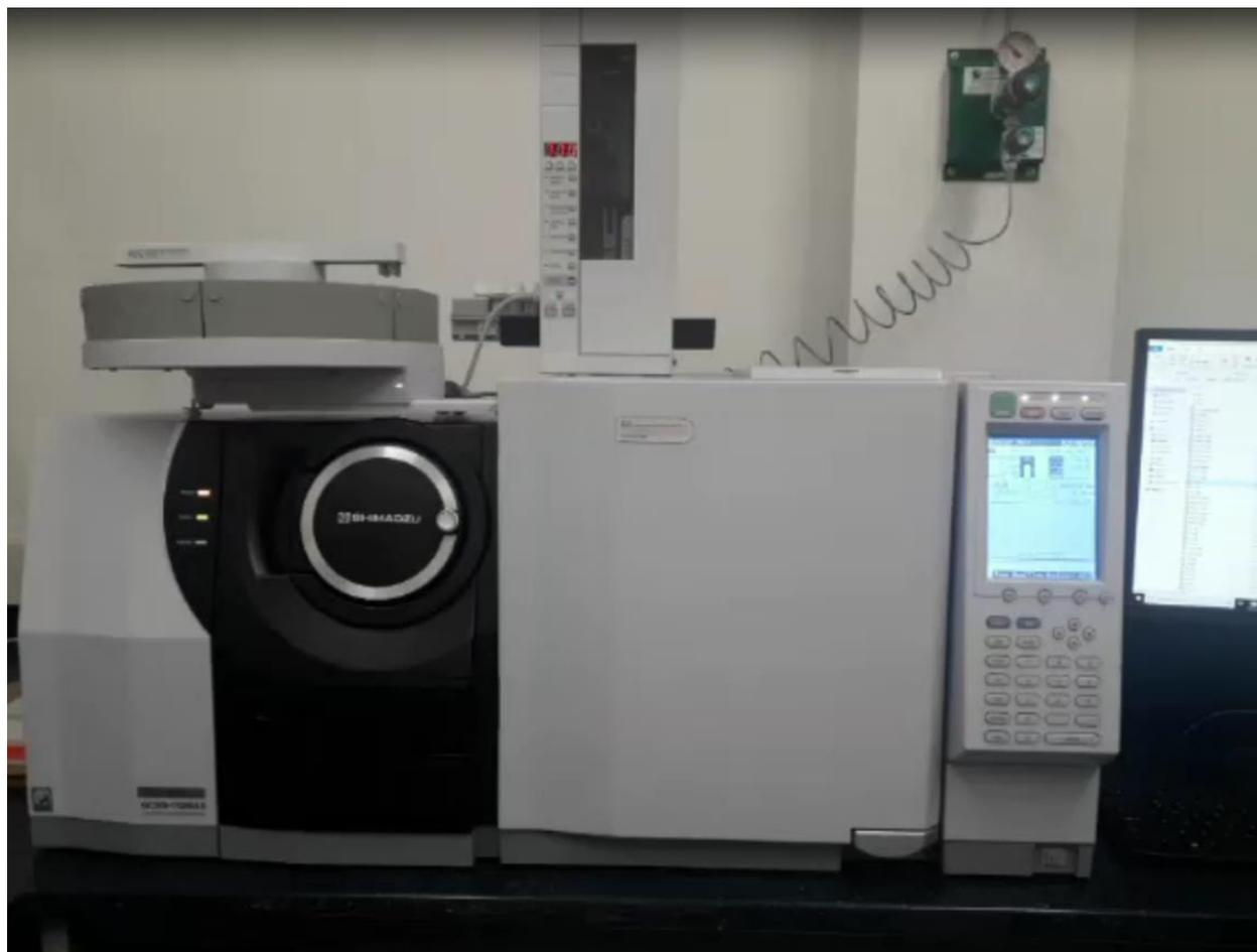
Figura 9. Cromatógrafo de gases Shimadzu GC2010 acoplado a un detector selectivo de masas MS/GCTQ8040
