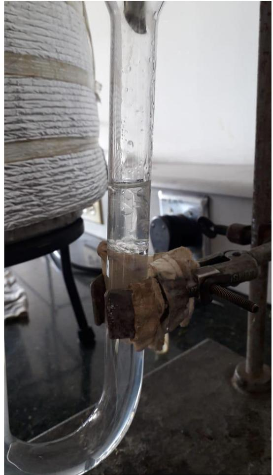
Figura 8. Aceite extraído mediante la técnica destilación por arrastre de vapor
