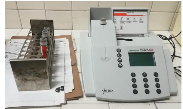
Figura 9. Spectroquant NOVA 60
