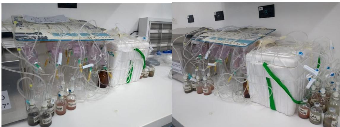
Figura 10. Montaje para la determinación de Desplazamiento por NaOH al 3% ejercida por los lodos en estudio y su respectivo control
