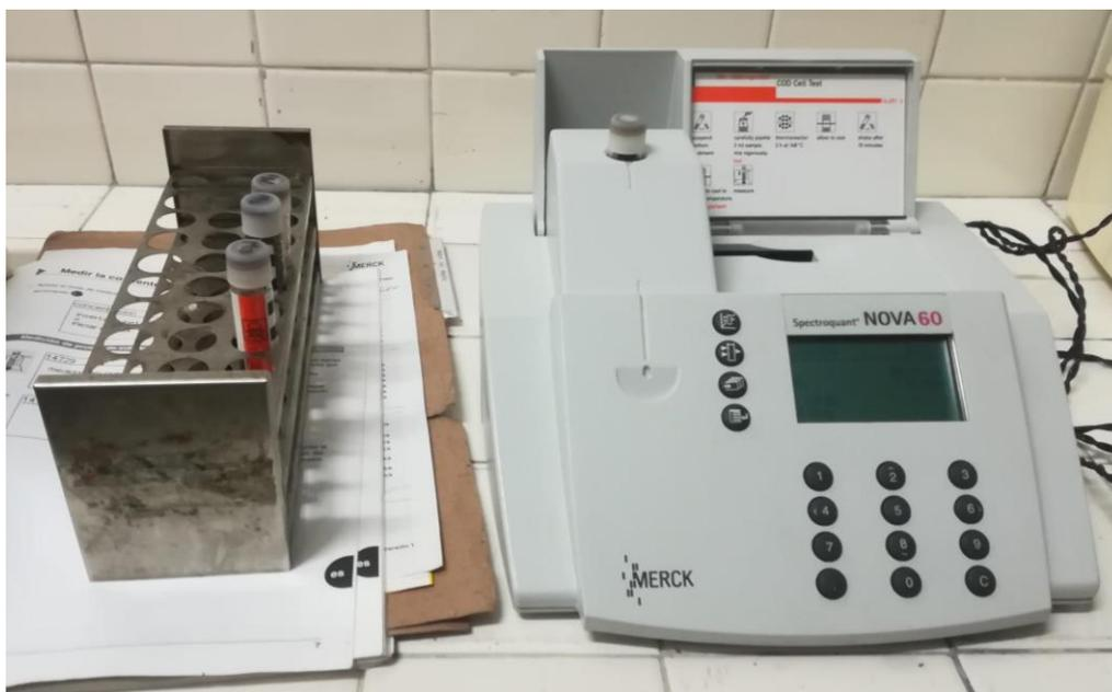
Figura 8. Equipo para determinación de DQO Nova 60
