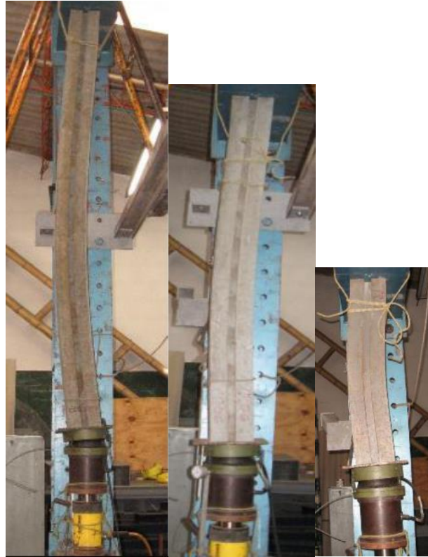
Ilustración 17 Modo de falla por pandeo de columna de 2,40m 1,60m y 0,80m respectivamente, en ensayo a compresión
