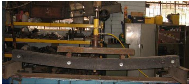
Ilustración 18 Flexión en viga acoplada de 2,40m durante ensayo a flexión (Sierra, 2016)
