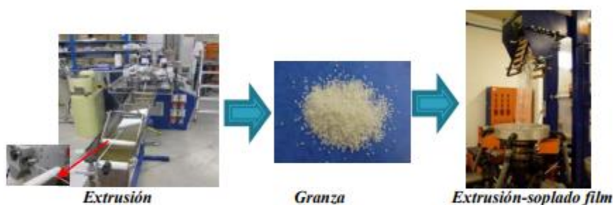
Ilustración 36: Extrusión, soplado de films (PEBD)
