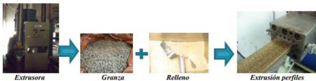
Ilustración 35 Proceso de Transformación (mezcla de PEAD/PP)
