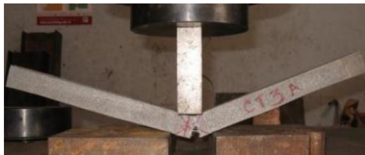
Ilustración 16 Modo de falla en el centro de la luz, ensayo a cortante (Sierra, 2016)
