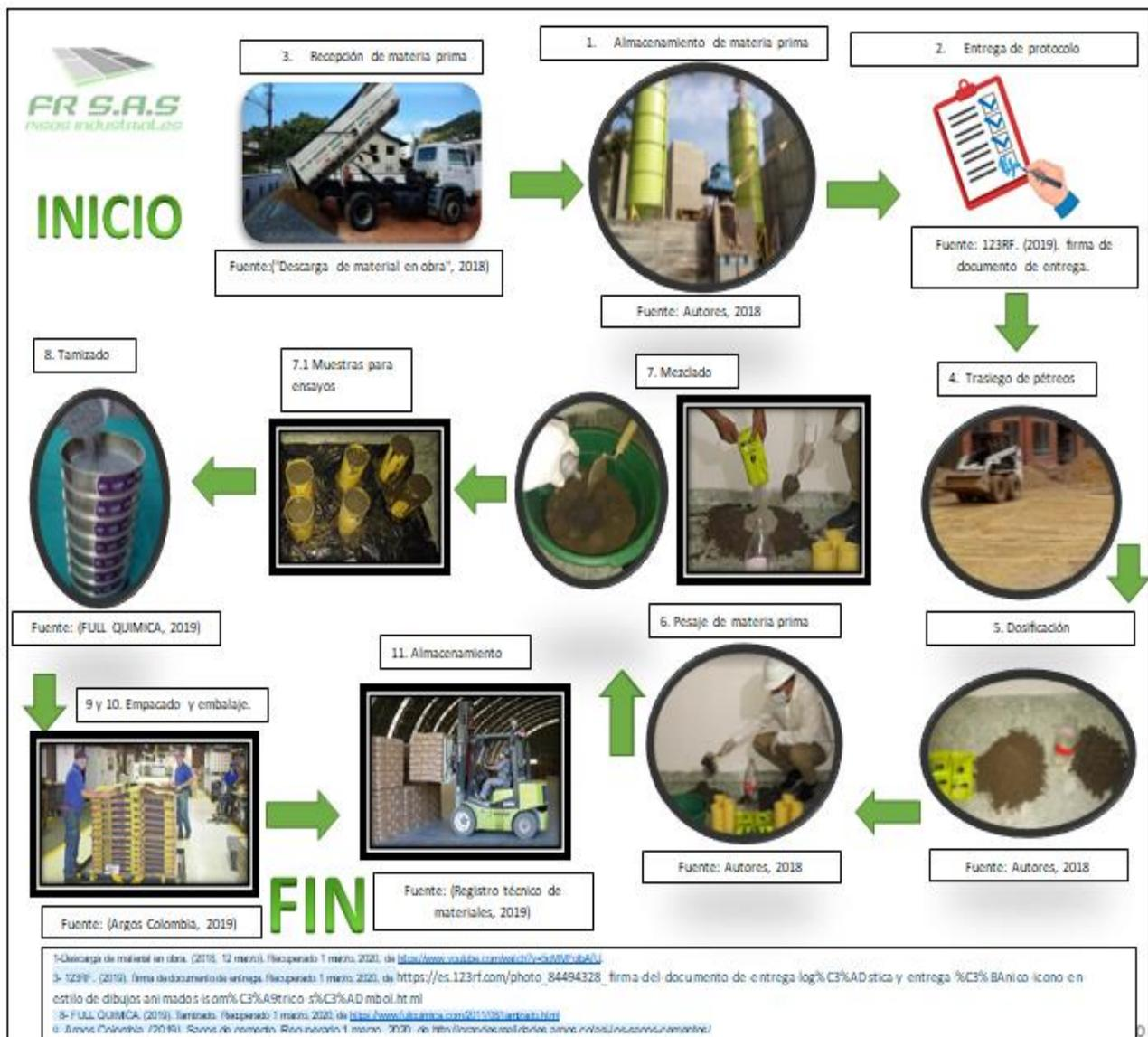
Figura 2. Diagrama de procedimiento de producción micro concreto con grafeno
