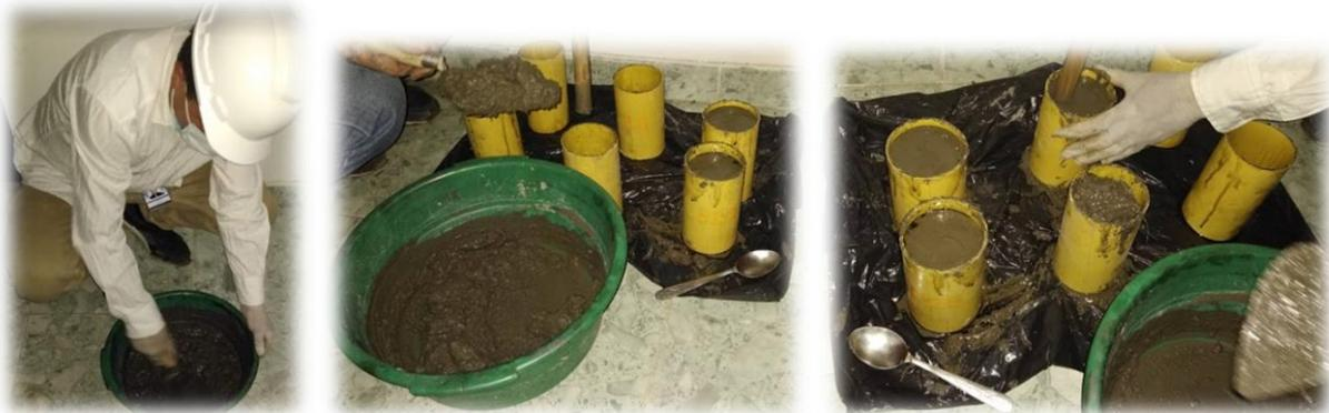
Ilustración44. Vaciado de mezcla
