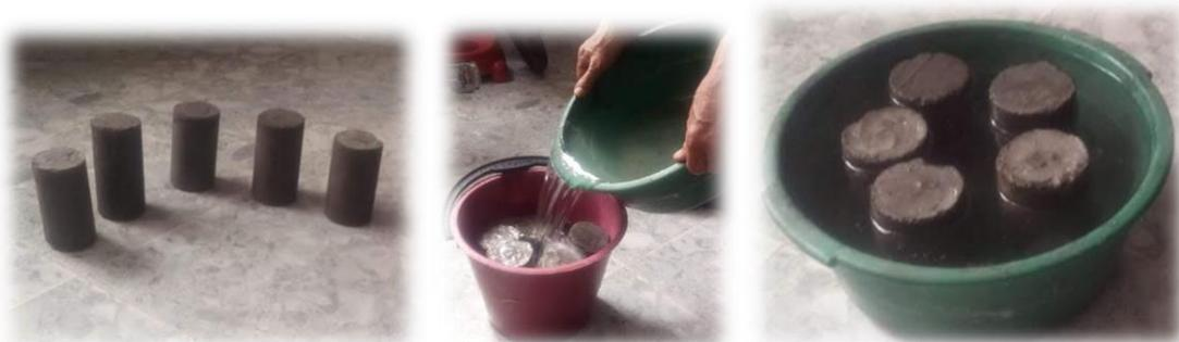
Ilustración46.Curado de cilindros
